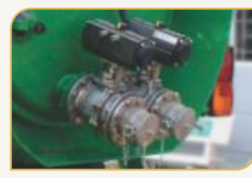
Đồng mở van hút, van xả bằng khí nén
